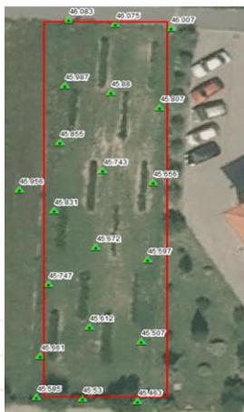
Piano quotato ottenuto con rilievo topografico
