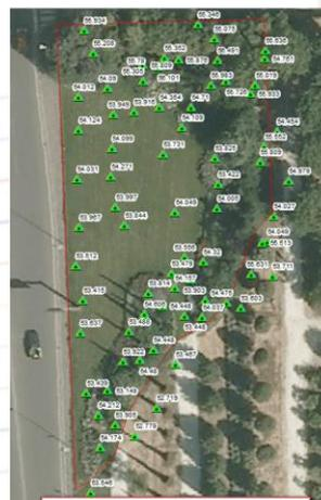
Piano quotato ottenuto con rilievo GPS
